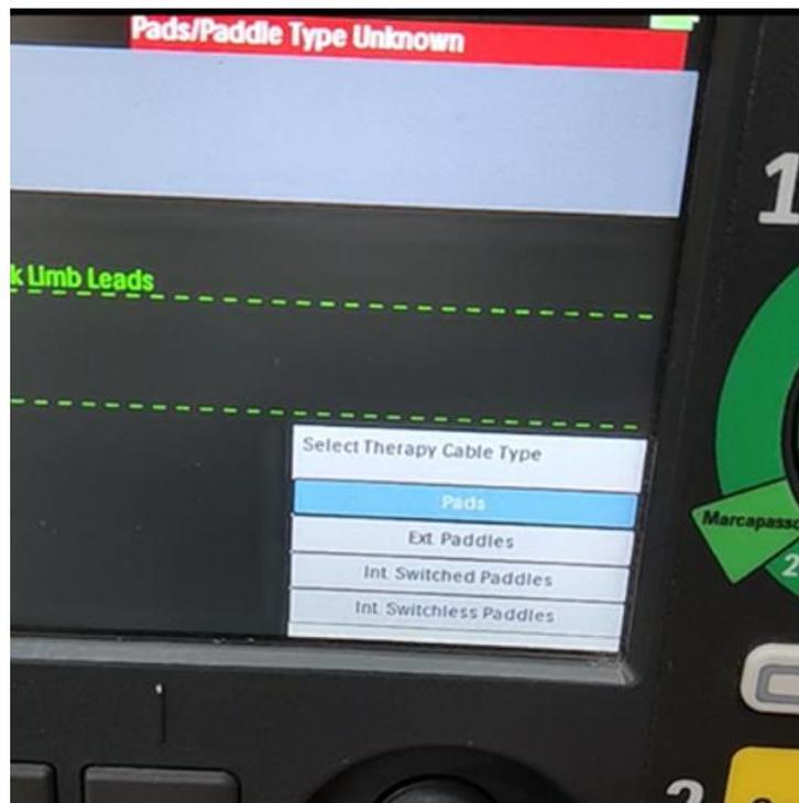
Abbildung 1: Anzeige eines DFM100 mit dem Paddle-Identifizierungs-Problem.
