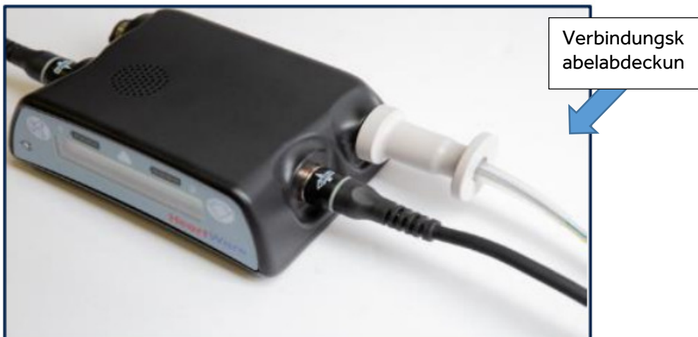
Abbildung 1: Steuereinheit mit über dem Verbindungskabelanschluss angebrachter Verbindungskabelabdeckung
