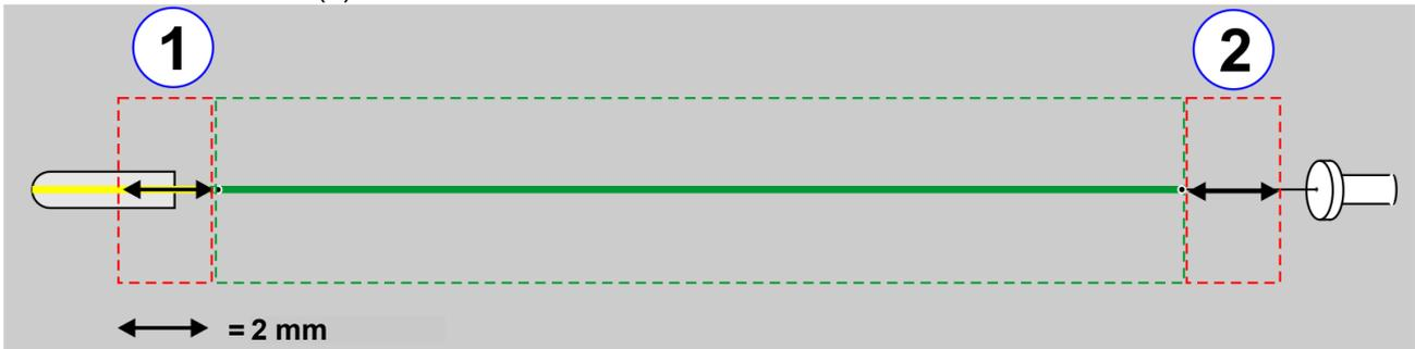
Abbildung 2. Ränder um den rekonstruierten Katheter. Die grüne gestrichelte Linie zeigt den 2-mm-Rand um den Katheter an. Die fehlerhaften Ränder werden am Spitzenende (1) und am Anschlussende (2) als rote gestrichelte Linien angezeigt.
