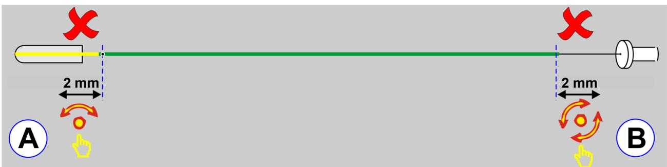
Abbildung 3. Szenarien A und B, in denen die Verwendung der Katheterbiegefunktion zu einem Rekonstruktionsfehler führen kann.
