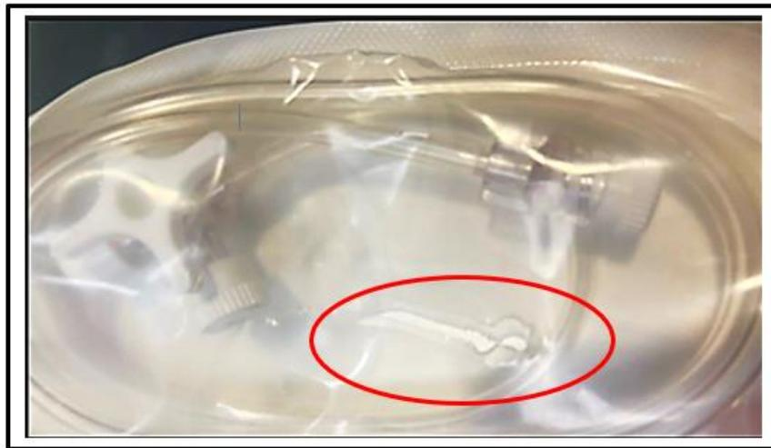
Figure 2 : Rupture au niveau de l'emballage blister
