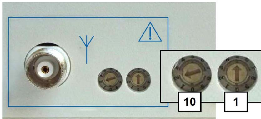
2. Utilizzare gli interruttori a codice sul pannello posteriore del ricevitore per selezionare il nuovo numero di canale.
