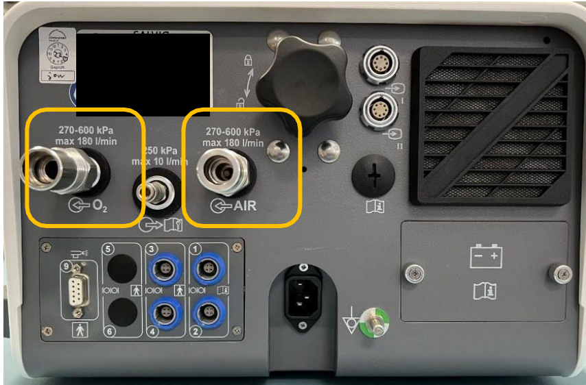
Figura 1: Vista posteriore di elisa 600/800 con connessioni NIST (montato correttamente)
