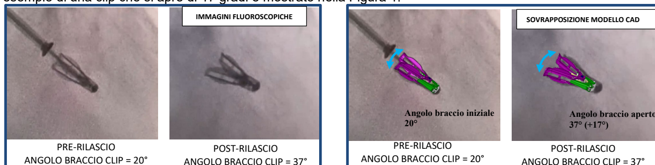
Figura 1: immagine fluoroscopica di un'apertura della clip mentre è bloccata (COWL) al rilascio (a sinistra) con sovrapposizione del modello CAD (a destra)
