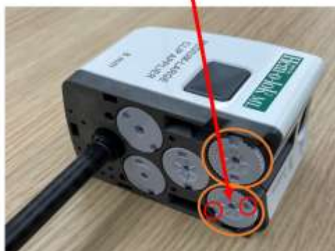
Figura 1 Applicatore di clip da Vinci X/Xi. Disco adattatore sterile con pioli evidenziati (sinistra). Dischi di entrata dello strumento con funzionalità di bloccaggio dei pioli e dischi di presa evidenziati (destra)
