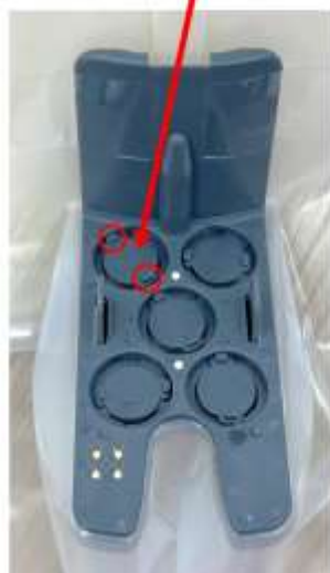
Figura 1 Applicatore di clip da Vinci X/Xi. Disco adattatore sterile con pioli evidenziati (sinistra). Dischi di entrata dello strumento con funzionalità di bloccaggio dei pioli e dischi di presa evidenziati (destra)
