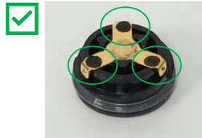
Coperchio della batteria non danneggiato - Continuare l'uso
