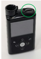
Batteriedeckel auf der Pumpe
