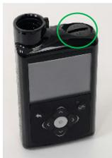
Der Batteriefachdeckel befindet sich auf der Oberseite der Pumpe, wo sich auch das AA-Batteriefach befindet.
