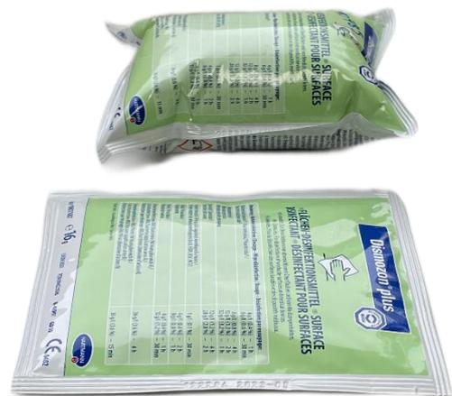
Abbildung 1: Dismozon® plus: ordnungsgemäßer Beutel (unten), geblähter Beutel (oben)
