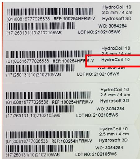
Auf dem zweiten Abziehetikett wird die Bezeichnung „HydroCoil 10“ wiederholt. Dies ist zwar korrekt, entspricht aber nicht der beabsichtigten Detailgenauigkeit. Beide Sätze der Abziehetiketten weisen diese Unstimmigkeit auf.
