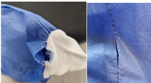
Abbildung 1 Fehlerhafte Nähte an Manschette und Naht
