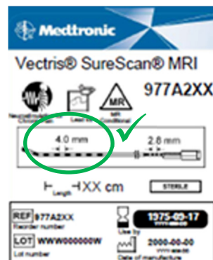
Immagine 2: Etichetta con corretta informazione in merito alla spaziatura tra gli elettrodi
