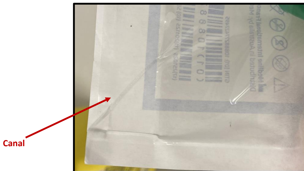
Image 1 : Exemple d'un scellage défectueux avec un « canal »
