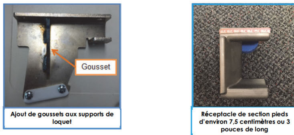
Fig. 3 : nouveau support de loquet avec gousset et réceptacle de section pieds plus long
