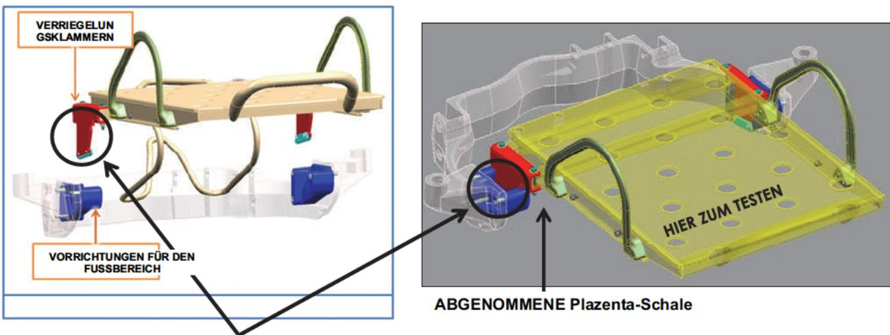
Die Verriegelungsklammern (rot in den Bildern) können verbogen werden, sollte das Teil herunterfallen. Achten Sie darauf, dass sie gerade und nicht zur Seite gebogen sind und fest in den Vorrichtungen (blau) sitzen.
