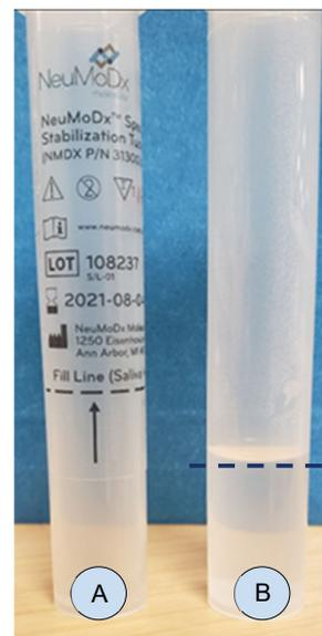
**Figura 1.** (A) Provetta di stabilizzazione del campione con linea di riempimento errata. (B) Livello di liquido che rappresenta la linea di riempimento corretta.
