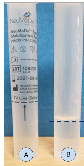
Abbildung 1. (A) Probenstabilisierungsröhrchen mit falscher Fülllinie. (B) Flüssigkeitsstand mit korrekter Fülllinie.
