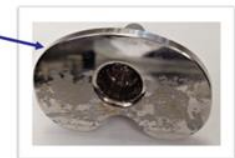
Image 2 : Exemple de présence de matériau résiduel sur la surface de l'implant
