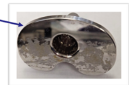
Bild 2: Beispiel für Restmaterial auf der Implantatoberfläche
