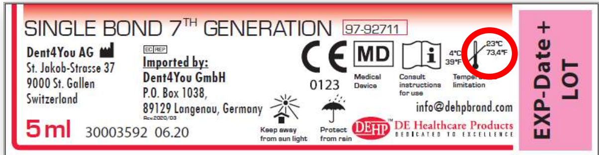
Abbildung 1: Kennzeichnung (Primärverpackung) Single Bond 7th Generation mit falscher Temperaturangabe (rot markiert)
