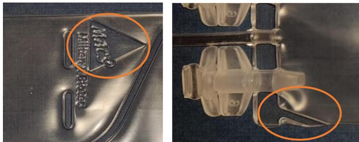
Das MACS-Logo muss vollständig sichtbar sein und die Versiegelungen an den Twist-off-Ports müssen ganz bis zum Rand des Freezing Bags reichen. In diesem Zustand ist eine sichere Verwendung gewährleistet.
