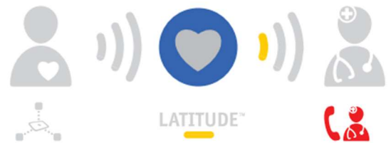
Abbildung 3. Oben: die Datenübermittlung bei der Verbindung zum LATITUDE-NXT System schlägt fehl. Auf dem Communicator wird eine gelbe Sendewelle angezeigt. Unten: Wird ein Implantat-Alarm nicht übermittelt, wird auf dem Communicator das rote Symbol für „Arzt anrufen“ angezeigt.
