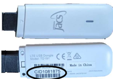
Abbildung 1. Bilder der Vorder-/Rückseite des 4G LATITUDE Mobilfunk-Adapters. Die CID-Kennzeichnung zeigt die Seriennummer.
