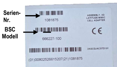
Abbildung 2. Produktetikett auf dem 4G LATITUDE Mobilfunk-Adapter, des (BSC-) Modells 6227 von Boston Scientific.
