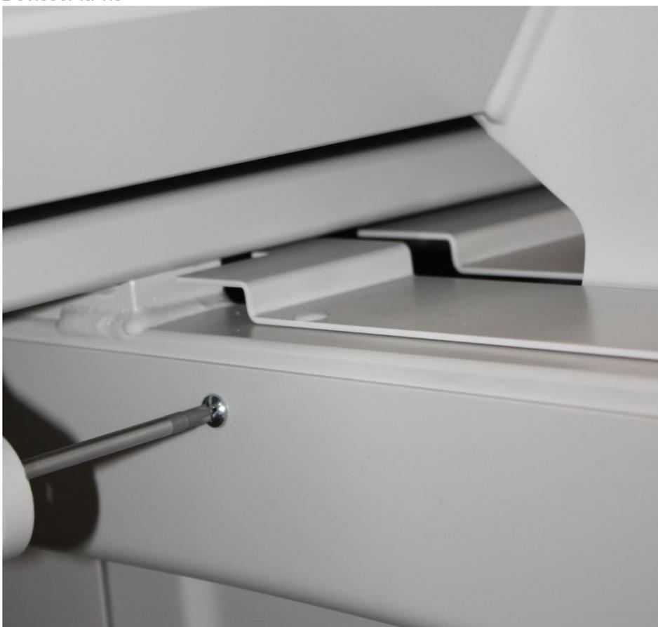
3. Démonter les deux fixations rapides de retenue du carénage en les tirant légèrement.
