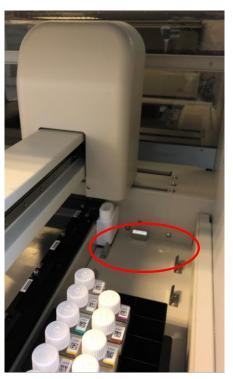
Den Bereich um die Waschstation (rot markierter Bereich) per Sichtprüfung auf Anzeichen einer unerwarteten Leckage (Salzrückstände und/oder Flüssigkeit) überprüfen. Dies kann auf eine Leckage am Z-Kopf oder einen zu hohen Pumpendruck hinweisen.
