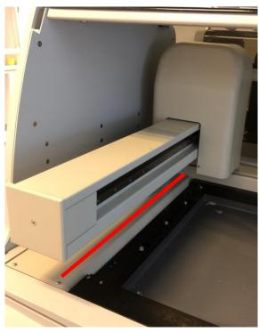
Die linke Platte (rot markierter Bereich) per Sichtprüfung auf Anzeichen einer unerwarteten Leckage (Salzrückstände und/oder Flüssigkeit) überprüfen. Dies kann auf eine Leckage am Roboterarm hinweisen.
