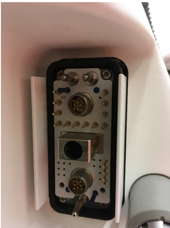
Abbildung 2: X10-Anschluss ohne eingesteckten Hauptkabelstecker (Beispiel)
