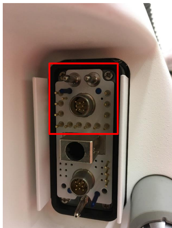
Abbildung 3: Kontaktstiftbereich des X10-Anschlusses, der nicht berührt werden darf (Beispiel)
