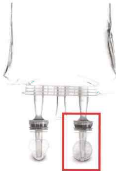
Abb. 1: Ecobag® mit abbrechbaren Port-Kappen. Der rot beschriftete Zuspritzport ist möglicherweise durch eine unregelmässige Wandstärke und Löcher ausserhalb der Portmembran beeinträchtigt.
