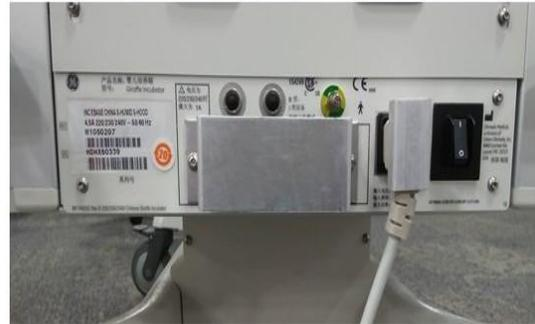
Figura 3: Il modulo Servo ossigeno NON è installato
