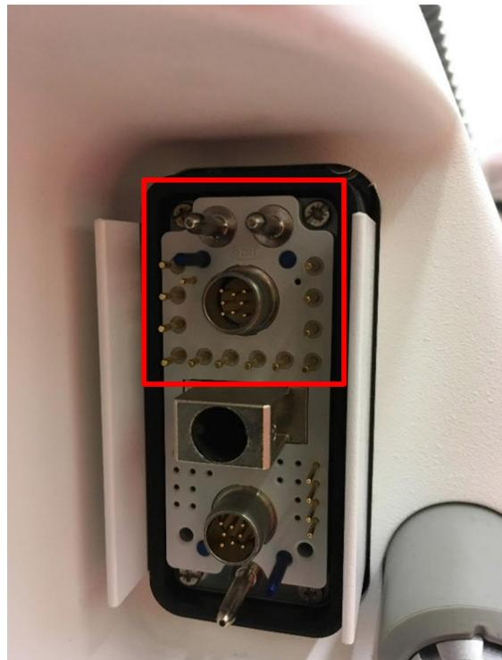
figure 2 : exemple de prise X10 avec zone des broches de contact à ne pas toucher
