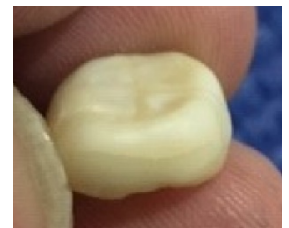
Rissbildung in der Krone nach dem Sintern
