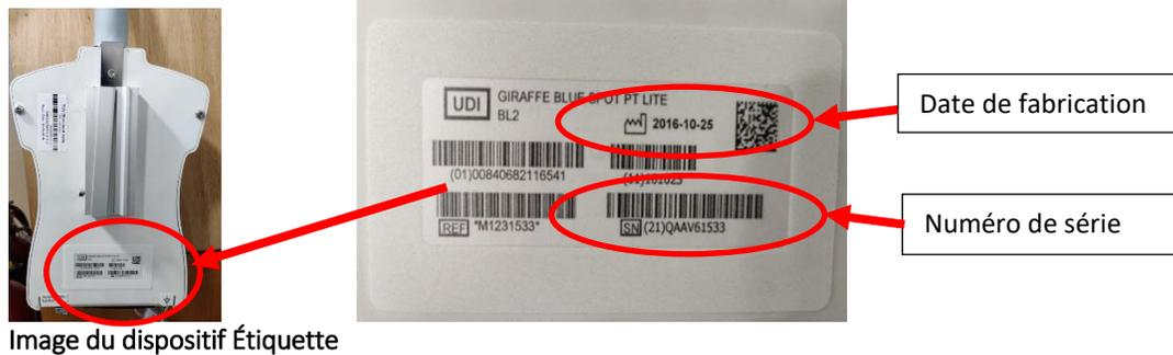
Afin d'identifier le numéro de série du conducteur de lumière, retirez le conducteur de lumière à fibre optique en vous reportant à la section 7.4.1 du Manuel de service.
