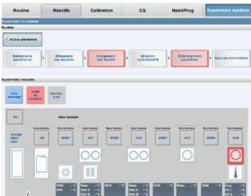
Sélectionner le pack de réactifs à masquer sur le rotor, puis cliquer sur masque pack R.
