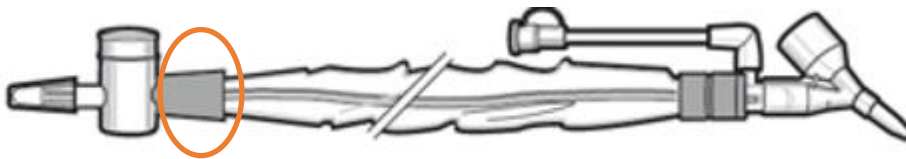
Illustration 2 : Endroit où l'occlusion potentielle a été identifiée. Ce blocage n'est pas visible pour l'utilisateur.
