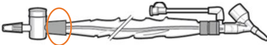
Illustration 1 : Endroit où l'occlusion potentielle a été identifiée. Ce blocage n'est pas visible pour l'utilisateur.
