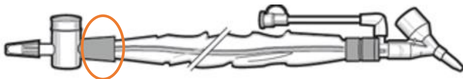
Abbildung 2: Stelle, an der die potenzielle Okklusion identifiziert wurde. Die Verstopfung ist für den Anwender nicht sichtbar.
