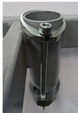
6. Die Schraube verbiegt sich, wenn sie stark angezogen wird. Das Foto zeigt den korrekt montierten Nachrüstsatz. Die Schrägstellung des Oberteils ist gewollt, sorgt für ein Verklemmen der Schraube und fungiert damit als Losdrehssicherung. Der Nachrüstsatz passt sich flexibel an alle Betten der Hermann Bock GmbH an.
