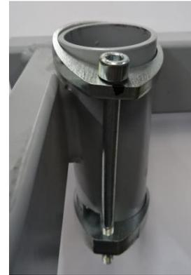
6. Die Schraube verbiegt sich, wenn sie stark angezogen wird. Das Foto zeigt den korrekt montierten Nachrüstsatz. Die Schrägstellung des Oberteils ist gewollt, sorgt für ein Verklemmen der Schraube und fungiert damit als Losdrehsicherung. Der Nachrüstsatz passt sich flexibel an alle Betten der Hermann Bock GmbH an.
