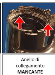
Anello di collegamento DANNEGGIATO
