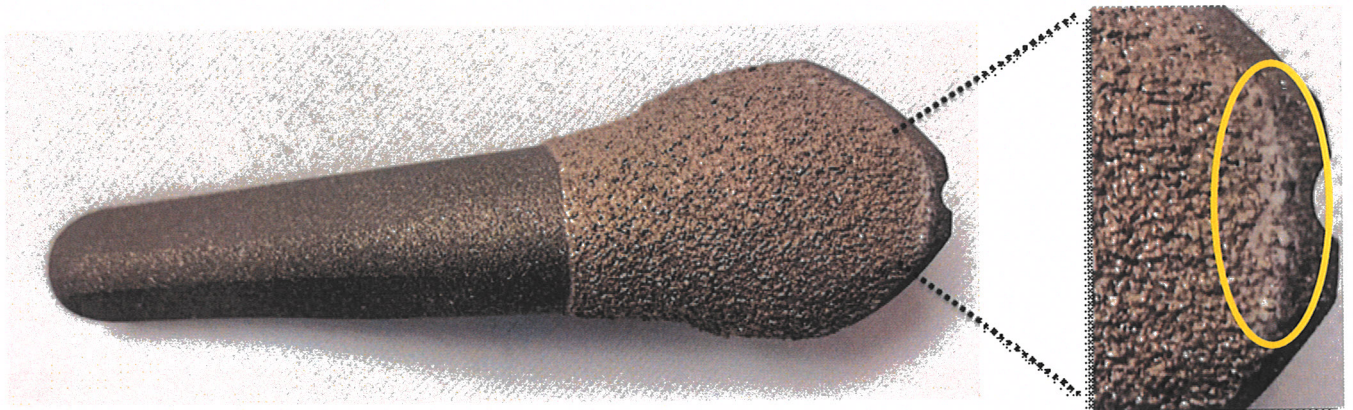
Figure 2. Débris de PETG sur tiges PTC (particules)
