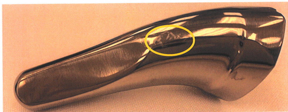
Figure 3. Débris de PETG sur tiges cimentées (film)
