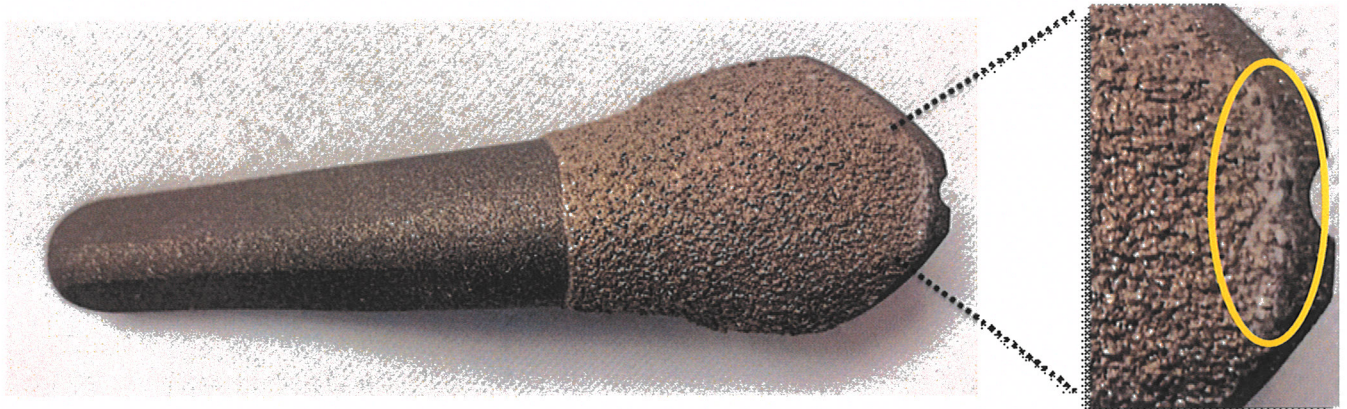
Abb. 2: PETG-Rückstände auf PTC Schäften (Partikel)
