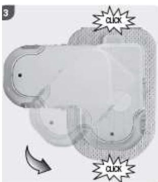
4 Assurez-vous que la micropompe s'enclenche correctement dans les ergots à l'avant et à l'arrière du support de pompe. Si ce n'est pas le cas, appuyez sur le couvercle de la pompe jusqu'à ce qu'elle s'enclenche dans le support de pompe.
