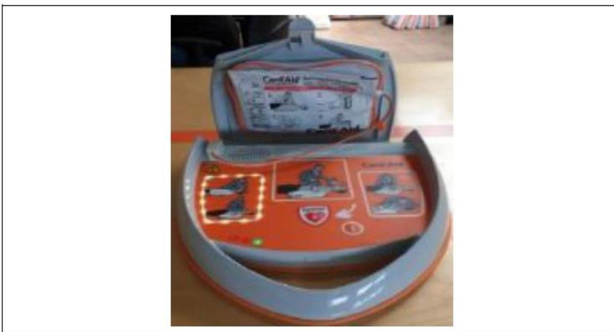
4) Rimuovere con cura il cavo dell'elettrodo che si collega al DAE e posizionare i vecchi elettrodi in un luogo sicuro, in modo da non mescolare i vecchi elettrodi interessati dal problema con quelli corretti inviati in sostituzione.
