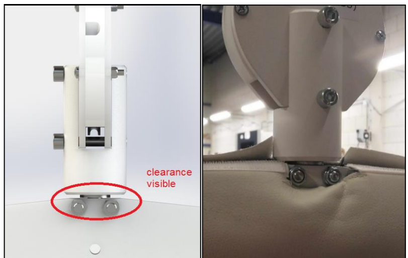
Bild 1: Achten Sie darauf, dass der Abstand zwischen dem Bügel und der Kabelführung deutlich sichtbar ist.
