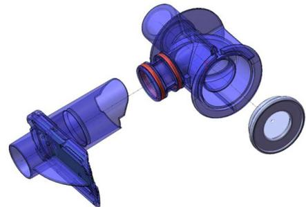
Nous avons pu détecter un durcissement prématuré de la membrane silicone selon le produit utilisé lors de la phase de désinfection par immersion.
