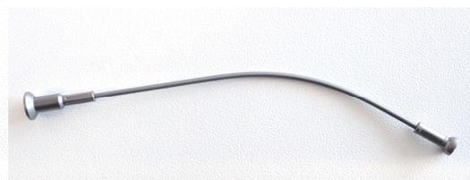
Foto des Nitinol-Zugkabels (glattes
