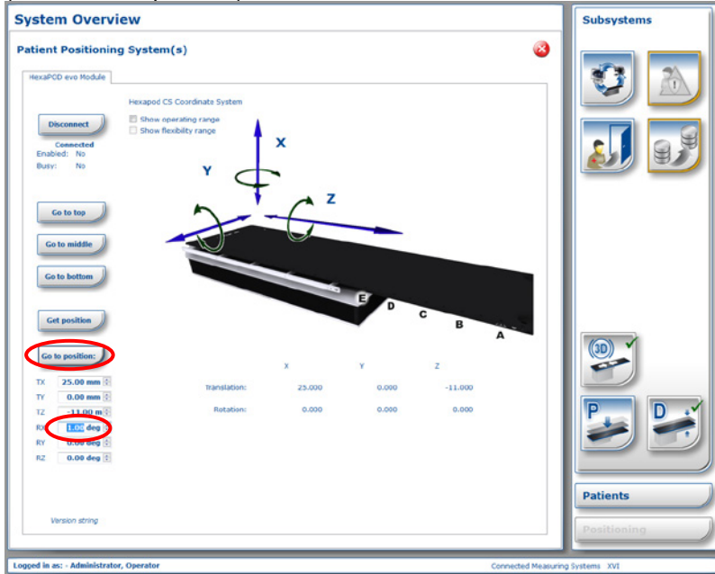
Fig. 6 : Effet sur l'isocentre lorsque l'HexaPOD pivote
