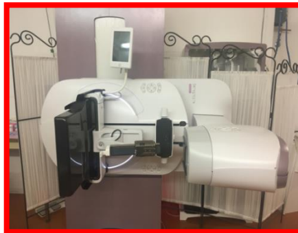
Figura #3 – Non usare la rotazione del sostegno per procedure biottiche : Sostegno del Senographe Prestina ruotato a 90°.
