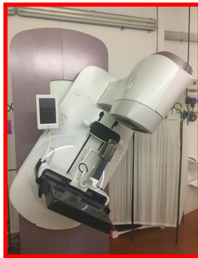
Figura #4 – Non usare la rotazione del sostegno per procedure biottiche : Sostegno del Senographe Prestina a QUALSIASI rotazione diversa da 0°.
