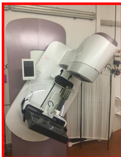
Figure n° 4 – N'utilisez pas la rotation du statif pour la procédure de biopsie : Statif du Senographe Pristina à TOUT angle de rotation autre que 0°.
